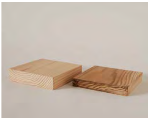
圧縮による厚さの変化 （左：圧縮前、右：圧縮後）
